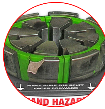
Broken Die Finger
